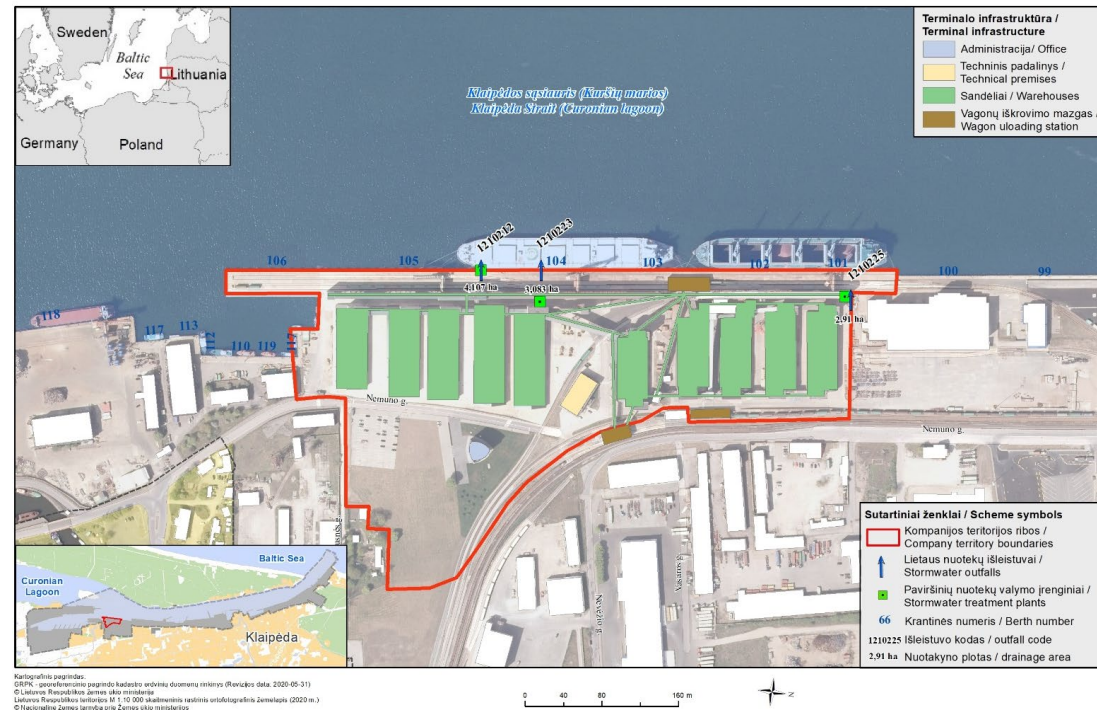
Klaipėdos Birių krovinių terminalo paviršinių nuotekų schema Klaipėda Bulk Cargo Terminal stormwater runoff scheme
